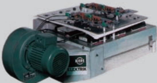
IGBT-Gleichstromsteller-Prototyp IGS 101 IGBT-Chopper-Prototyp IGS 101
